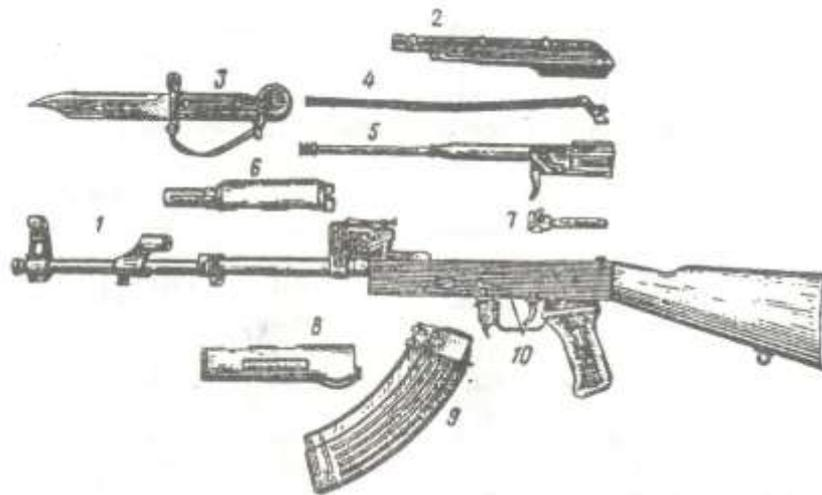
Рис. 7. Основные части и механизмы автомата:
